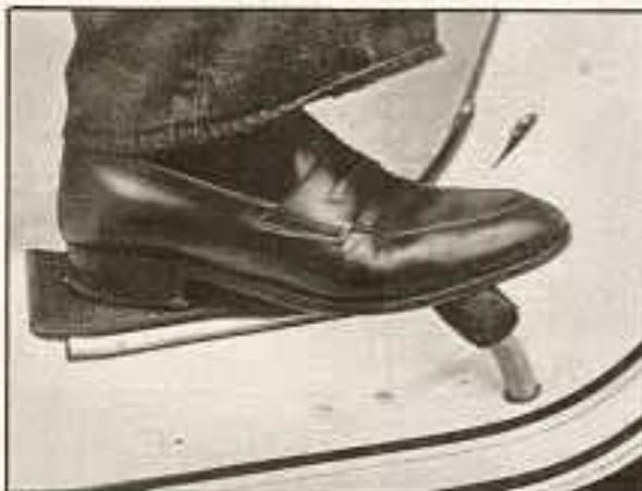
Tenendo il piede sul rialzo centrale della pedana, provvisto di rivestimento in gomma, è possibile azionare con la dovuta prontezza il pedale del freno posteriore dotato anch'esso di gommino antisdrucciolevole.
