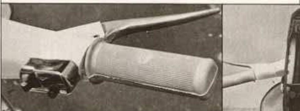
Facilmente raggiungibili col pollice, senza staccare la mano dalla manopola del gas, i veri comandi dell'impianto elettrico; le manopole in gomma sono di grosso diametro per facilitarne la rotazione, specialmente di quella del cambio; di profilo, un po' esile e distanti dalle manopole risultano invece le leve del freno e della frizione.
