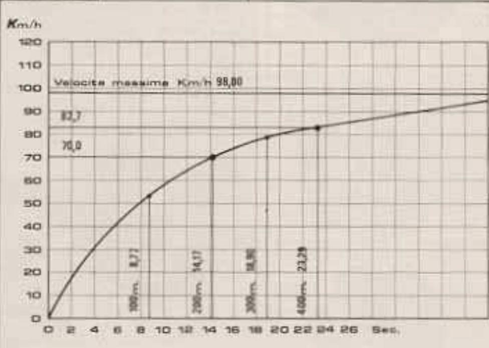
Il diagramma dell'accelerazione rilevato dalla nostra Rivista durante le prove sulla pista Pirelli.
