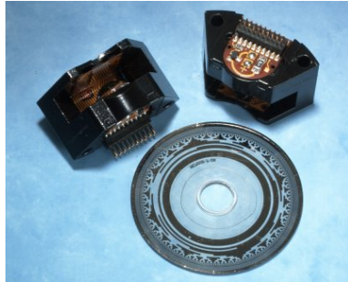
Figura 2.5: Encoder ottico assoluto
