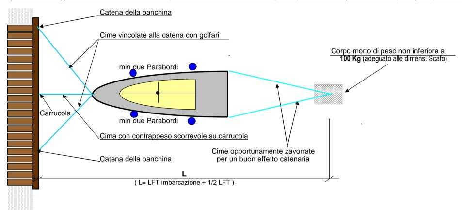
Si ricorda che gli ormeggi al pontile non devono essere realizzati eseguendo fori sulle travi, sui pali o sulle trutture in legno, ma realizzati con golfari metallici ammanigliati alla catena del pontile.
