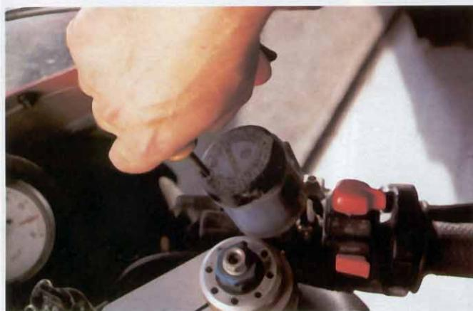
Prima di rimuovere il tappo del serbatoio del liquido dei freni (sul quale è di norma indicato il tipo di liquido da impiegare), pulirlo accuratamente assieme alla zona circostante.
