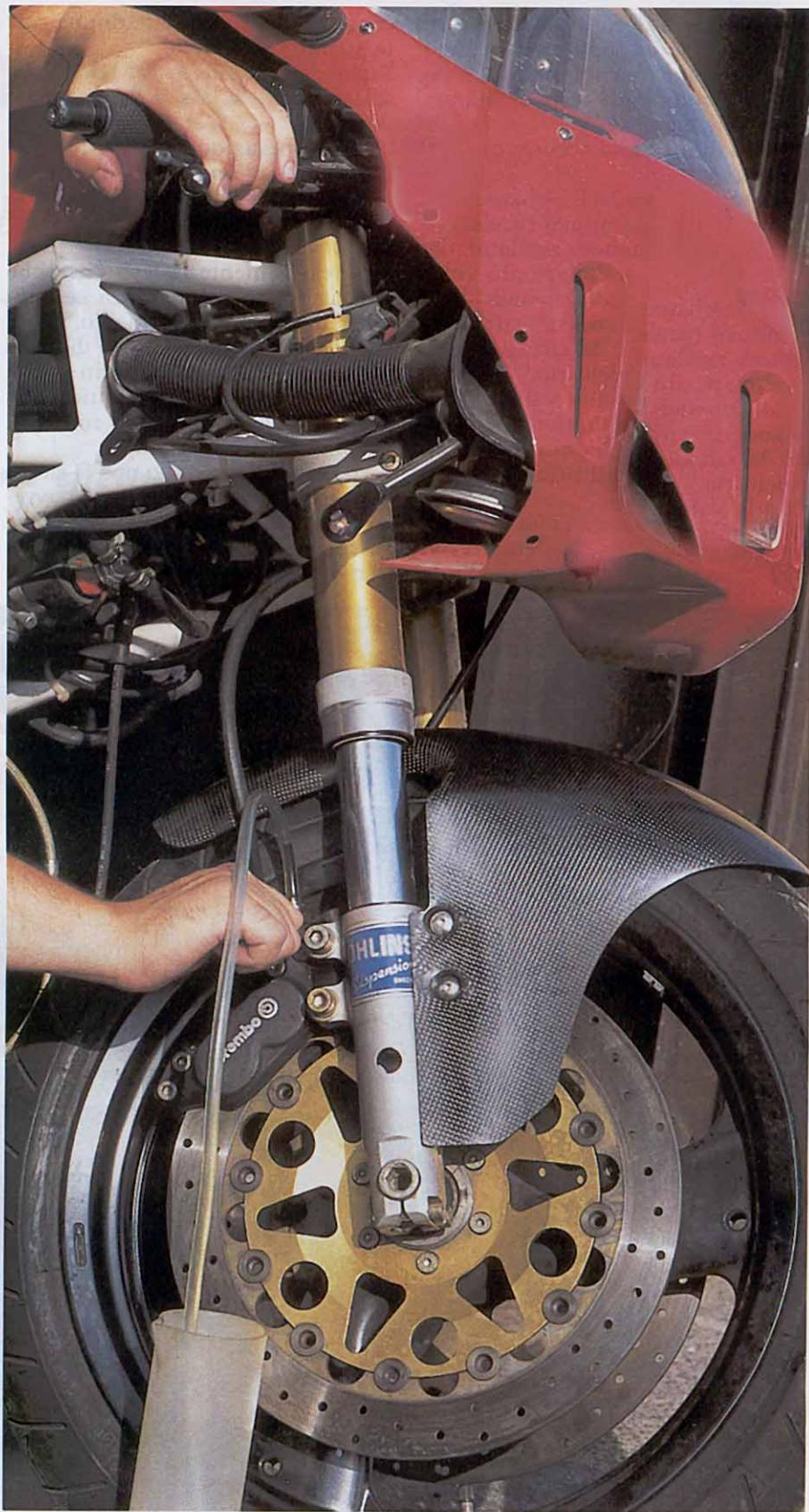
*Disporre il manubrio in modo tale che la pompa (e in particolare la parte nella quale si trovano i forellini di collegamento al serbatoio) non si venga a trovare più in basso del raccordo di fissaggio della tubazione.*
