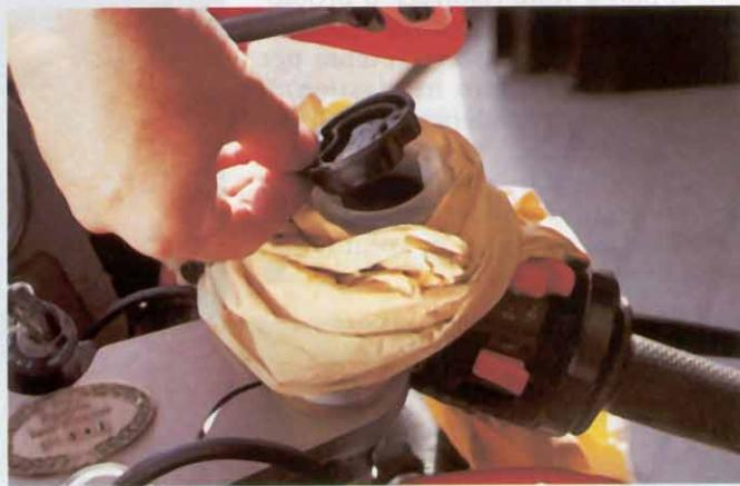
Disporre un panno attorno al serbatoio al fine di evitare che qualche goccia di liquido dei freni possa finire sulle parti verniciate della moto. Rimuovere la membrana.
