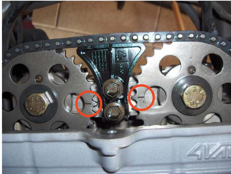
Rimontando chiaramente le due linee devono essere ancora parallele alla testa e si può vedere che le valvole sono nella posizione di partenza..
