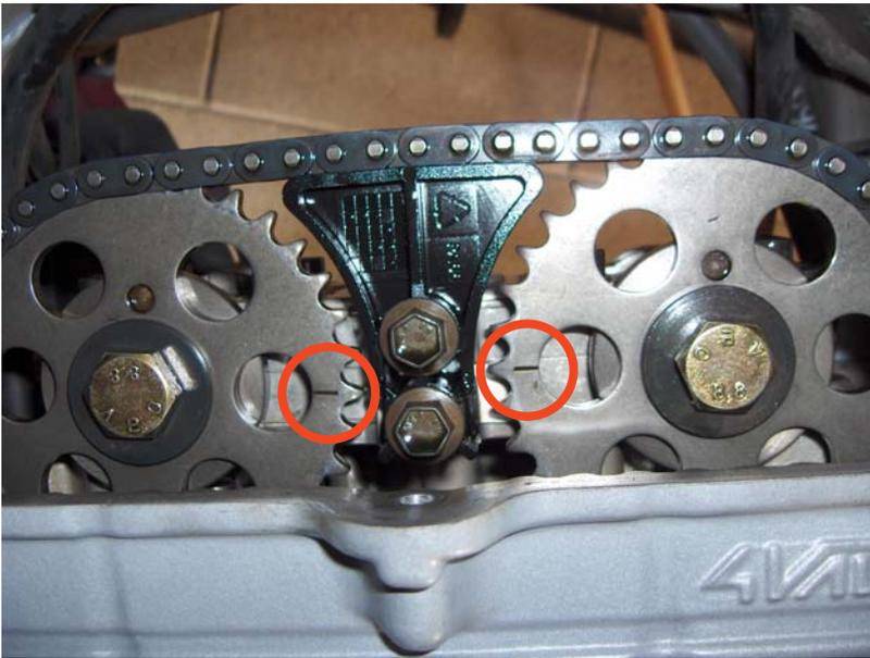
Il PMS si può trovare in diversi modi, in questo caso è utile guardare le due linee poste sulle ruote dentate; queste devono affiancate e parallele alla testa del motore.
