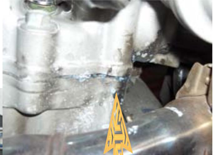
A circa 32 mila KM, all'altezza dello scarico di destra (lato bulbo dell'acqua) sono iniziate a comparire delle piccole macchioline d'acqua, arrivando a macchiare tutto il cilindro. Aumentando i giri del motore aumenta la perdita d'acqua, fino ad arrivare ad uno spruzzo a fontana.
