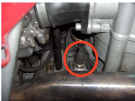
Svitiamo anche il sensore di pressione dell'olio, dopo avergli tolto il collegamento, per evitare di imprattarlo e che ci ostacoli lo smontaggio.
