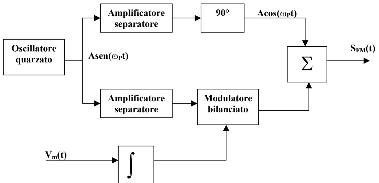
Chiaramente, come già precedentemente detto, tale circuito assolve la funzione di modulatore FM, con tecnica chiaramente indiretta, nel caso di basso valore di  $K_f$ , ovvero per  $m_f \ll 1$ . Ciò, però, non è una limitazione in quanto i valori più alti di deviazione di frequenza possono essere ottenuti applicando all'uscita di tale circuito un opportuno numero di moltiplicatori di frequenza.
