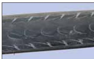
Tipici segni di usura sullo pneumatico e sulla camera d'aria.
