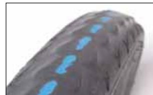
*Lo strato di protezione antiforature è visibile. Lo pneumatico dovrà essere sostituito urgentemente.*
