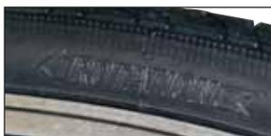
Sui fianchi della maggior parte degli pneumatici Schwalbe si trova una freccia che indica la direzione di marcia consigliata. Pedalando, la ruota deve ruotare in direzione della freccia. Gli pneumatici più vecchi hanno l'indicazione "DRIVE", ma il significato è lo stesso.
