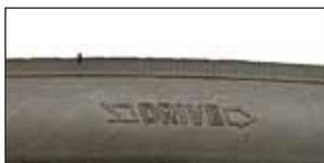
In molte coperture da MTB si vedono invece sia una freccia "FRONT" che "REAR". La freccia "FRONT" indica la direzione raccomandata per la ruota anteriore e la freccia "Rear" per la ruota posteriore.
