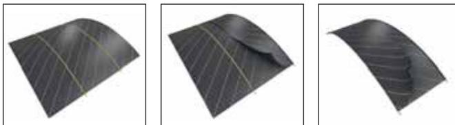
La carcassa viene applicata sul cilindro di confezionamento, poi viene tagliata e giuntata. Poi i fasci di filo o aramide vengono inseriti e la carcassa viene piegata su entrambi i lati. A questo punto il materiale della carcassa, disposto con un angolo di 45°, viene steso a strati e forma uno pneumatico con una struttura diagonale.
