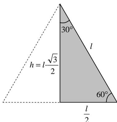
Misura dell'altezza in funzione dell'ipotenusa  $l$ . Supponiamo che il triangolo sia posto come in figura, con l'angolo maggiore adiacente alla base. Il cateto minore, per quanto detto, è la metà dell'ipotenusa e vale  $l/2$ . Per il teorema di Pitagora l'altezza  $h$  risulta poi uguale a:
