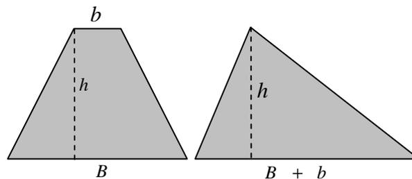
L'area di un trapezio è uguale al semiprodotto della somma delle misure  $B$  e  $b$  delle basi per la misura  $h$  dell'altezza.
