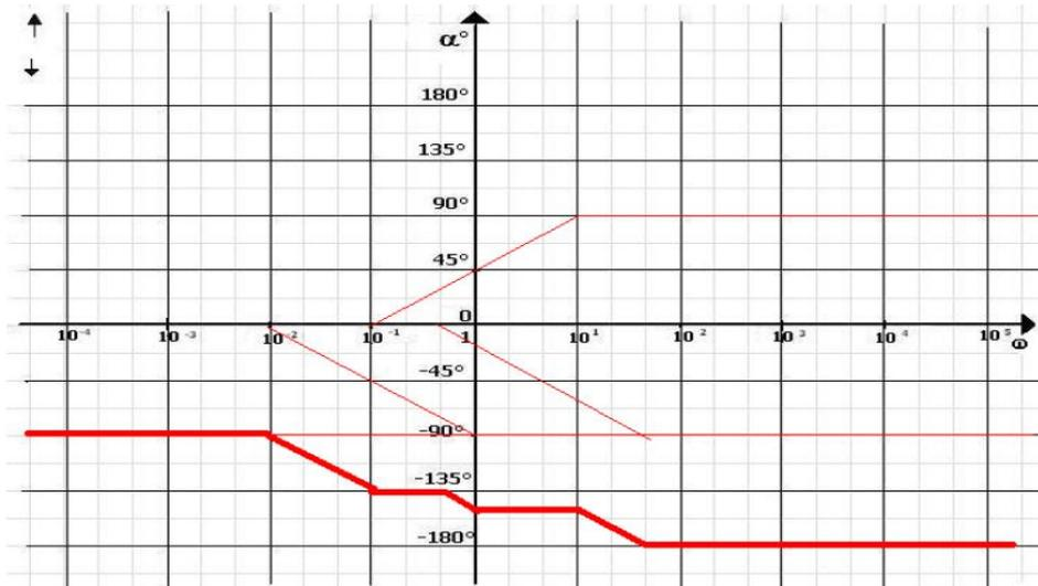
Essendo il modulo della fase, in corrispondenza della  $\omega_t = 2 \text{ rad/s}$  a 0 dB, inferiore a  $180^\circ$ , il sistema risulta **STABILE** e il margine di fase  $\phi_m = \text{circa } 180^\circ - 140^\circ = \text{circa } 40^\circ$ .
