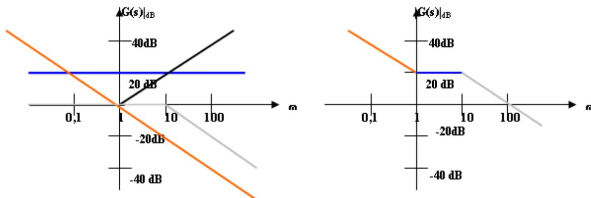
È un sistema stabile, perché taglia l'asse di  $\omega$  con una pendenza di -20[dB] e poi i poli sono reali negativi o zero.
