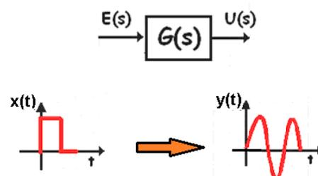
2- se l'ingresso è un segnale di tipo impulsivo, per caratterizzare un sistema stabile, la risposta deve tendere a zero e non essere limitata in ampiezza: quindi nel nostro caso il sistema è **INSTABILE**.
