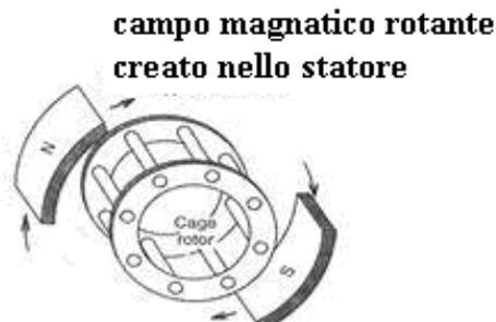
**MACCHINA SINCRONA** È detta sincrona quella macchina rotante in corrente alternata nella quale la frequenza della tensione indotta generata e la velocità di rotazione sono in rapporto costante.
