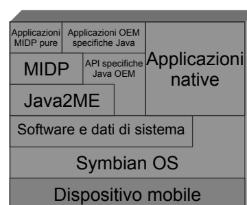
Figura 2. Architettura software di un tipico dispositivo mobile
