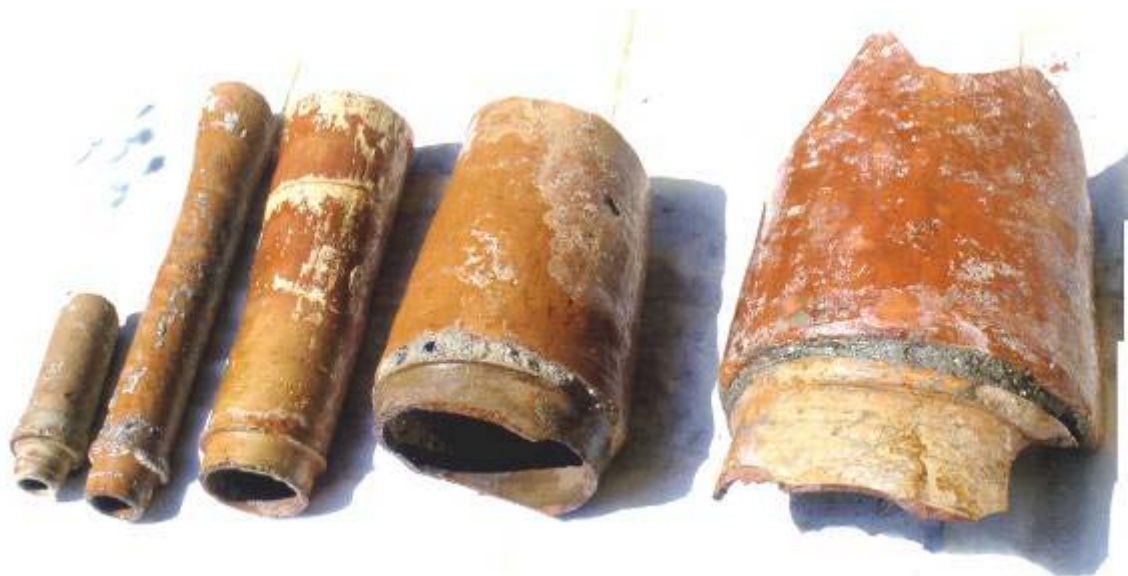
Fig. 13 Tipici catusi (tubi fittili) del palermitano
