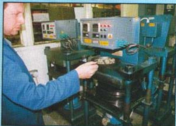
Gli "stagni" vengono fatti scaldare per 5 minuti, prima di essere posizionati nella gomma.
