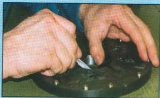
Si scavano i canali per permettere al metallo fuso di poter entrare e spingere fuori l'aria.
