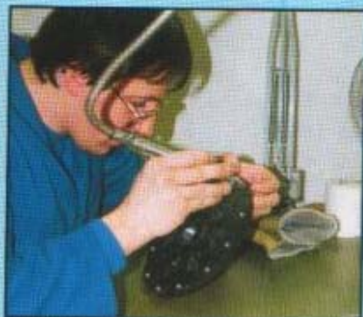
Vengono effettuati i fori per permettere all'aria di fuoriuscire mentre il metallo fuso viene colato.
