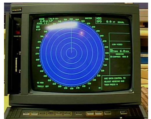
Fig. 17 Schermo di un radar ARPA.
