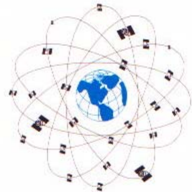
Orbite satellitari del sistema GPS.
