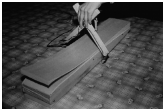
Le quattro sagome per il taglio ricavate in compensato ed il taglio della vista in pianta della fusoliera con l'archetto a filo caldo.
